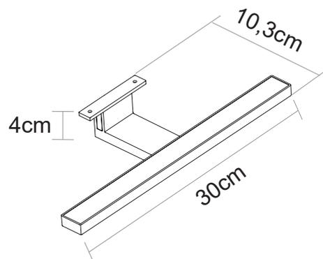
**PUÒ ESSERE FISSATA ALLO SPECCHIO, ALLA PARETE O ALLA SUPERFICIE DI UN MOBILE GRAZIE AL SET DI INSTALLAZIONE IN DOTAZIONE, GARANTENDO UN'OTTIMALE ILLUMINAZIONE.**
