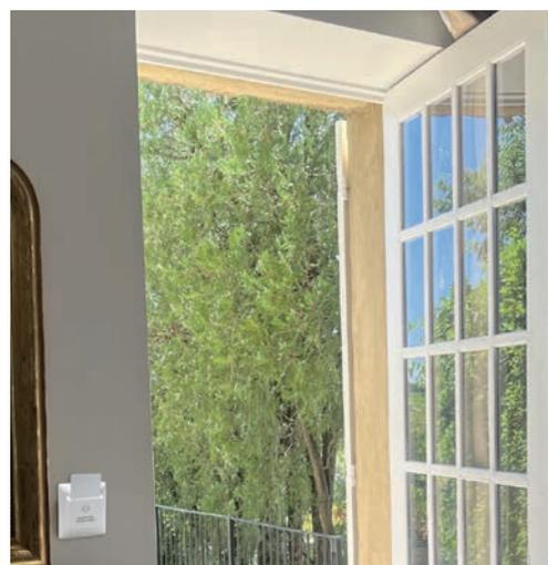
**ATTENZIONE!:** il modulo è dotato di un ritardo di cortesia, e rimarrà attivo per 15-20s circa dopo la rimozione della scheda RFID, successivamente l'interruttore si disabiliterà automaticamente
